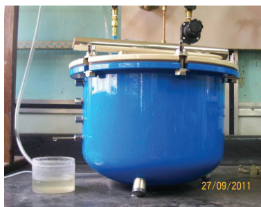
Fotografía 2. Olla de presión de Richards.
