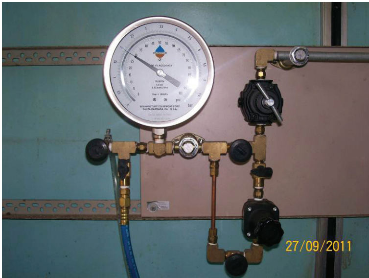
Figura 3. Olla de presión de Richards. Izquierda: columna de agua para determinaciones a bajas presiones Derecha: detalle del manómetro.
