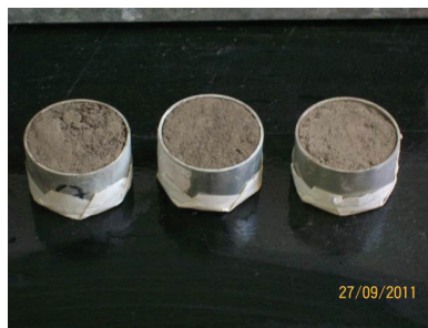
Fotografía 1. Muestras de suelo enrasadas y preparadas para su procesamiento, con papel de filtro en la parte inferior del anillo.
