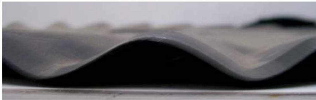
Figura 2 Imagen de la onda de la cuchilla con diseño Turbo de 20 ondas
