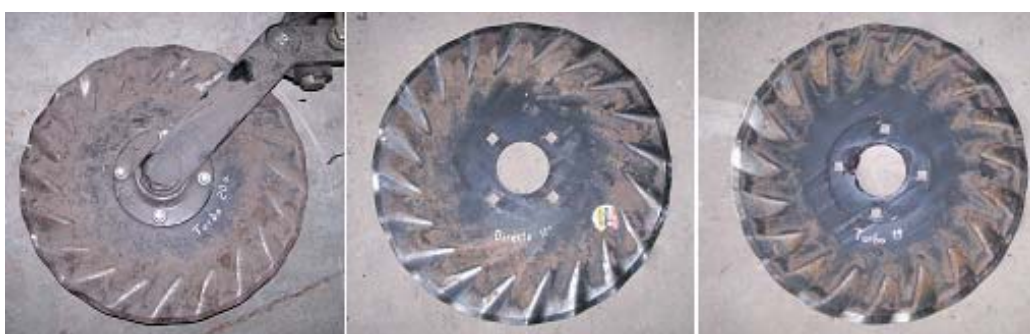
Figura 4: Detalle de tres de las cinco cuchillas empleadas en el ensayo. De izquierda a derecha, diseño Turbo de 20 ondas, diseño Directa de 20 ondas y diseño Turbo de 19 ondas.
